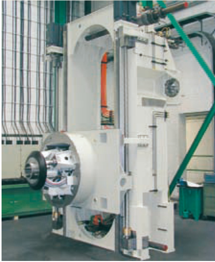
图3 安装在立柱上的Sprint Z3主轴头
